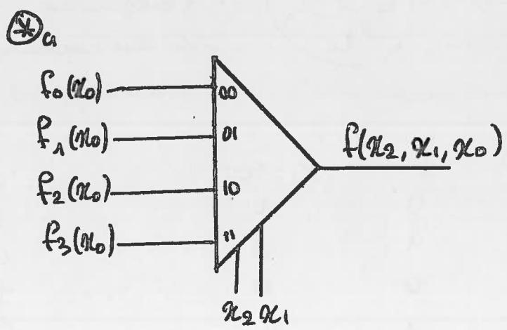
$(x_2, x_1, x_0), f_0(x_0), f_1(x_0), f_2(x_0), f_3(x_0)$  sono tutte a sola bit. funz. simpl. con una var. esterna
