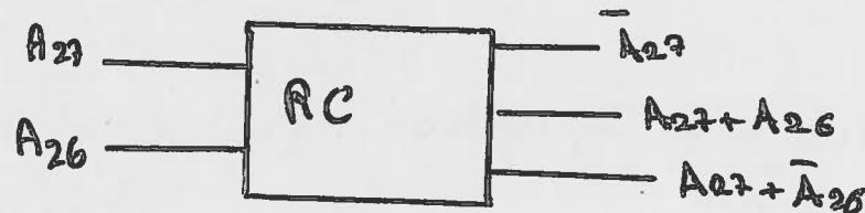
DECODER  $\rightarrow$  rete combinatoria che, dati  $n$  bit in ingresso, presenta in uscita  $2^n$  linee, una sola delle quali presenta un valore diverso dalle altre
