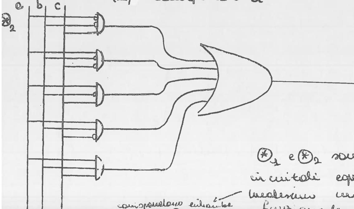
Q<sub>1</sub> e Q<sub>2</sub> sono due circuiti equivalenti del medesimo modello funzionale.
